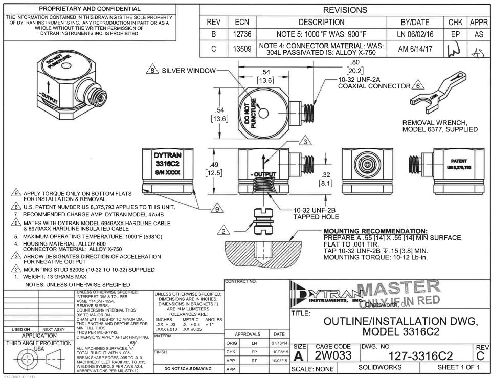
**Model Number** DOC NO PERFORMANCE SPECIFICATION 3316C2 PS3316C2 SINGLE AXIS CHARGE MODE ACCELEROMETER REV E, ECN 14095, 03/14/18
