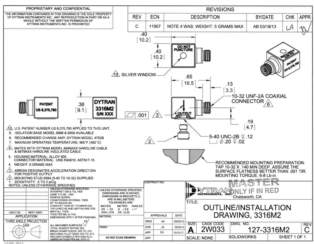
Model Number DOC NO PERFORMANCE SPECIFICATION 3316M2 PS3316M2 SINGLE AXIS CHARGE MODE ACCELEROMETER REV D, ECN 11683, 01/17/15
