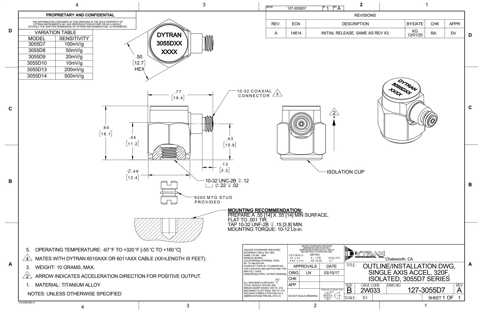
**Model Number** DOC NO PERFORMANCE SPECIFICATIONS 3055D7 PS3055D7 IEPE ACCELEROMETER REV B, ECN 16090, 03/02/21
