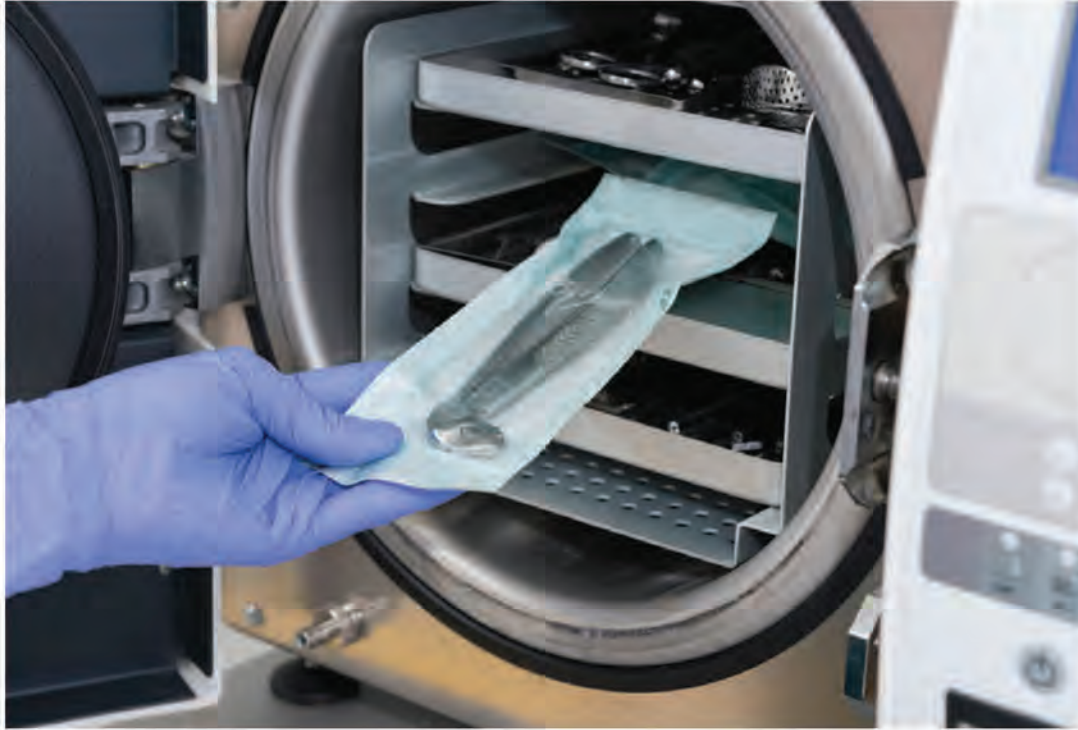
图中，压热箱可通过高压流对无菌可循环医疗设备进行病菌和其他病原体的消毒。
